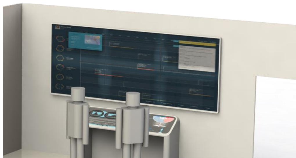
Figuur 21: Touch imitatie. De rand is voorzien van IR lampen en sesoren
