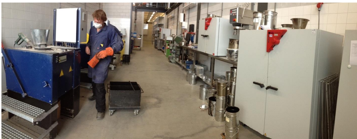
Het maken van het asfaltmengsel
