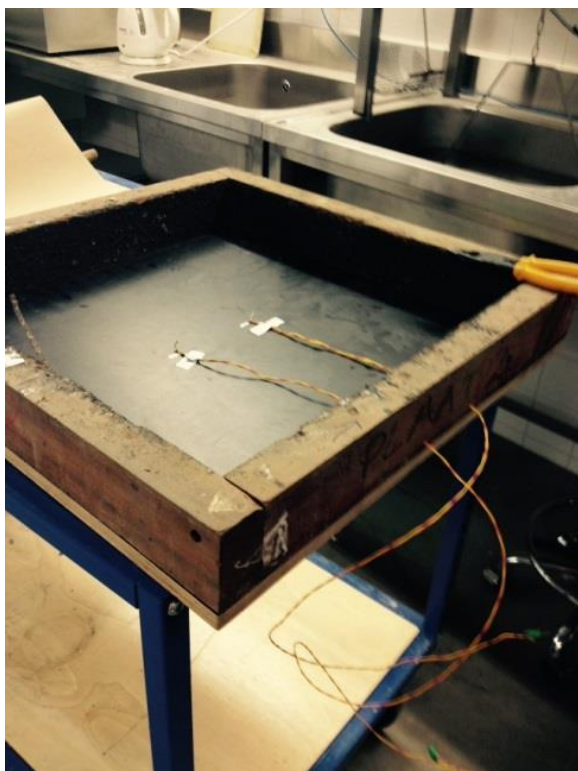
Het aanbrengen van thermokoppels
