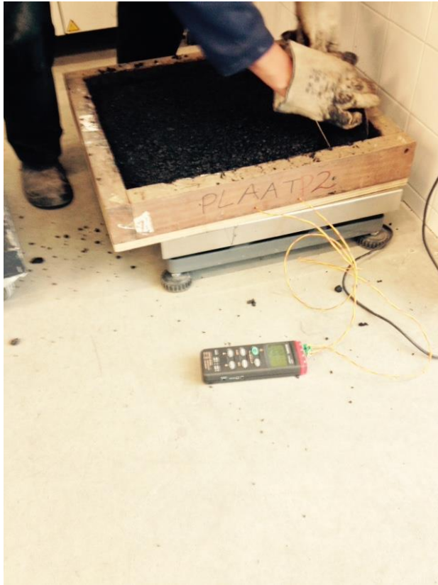
De aanleg van het asfalt in de kist
