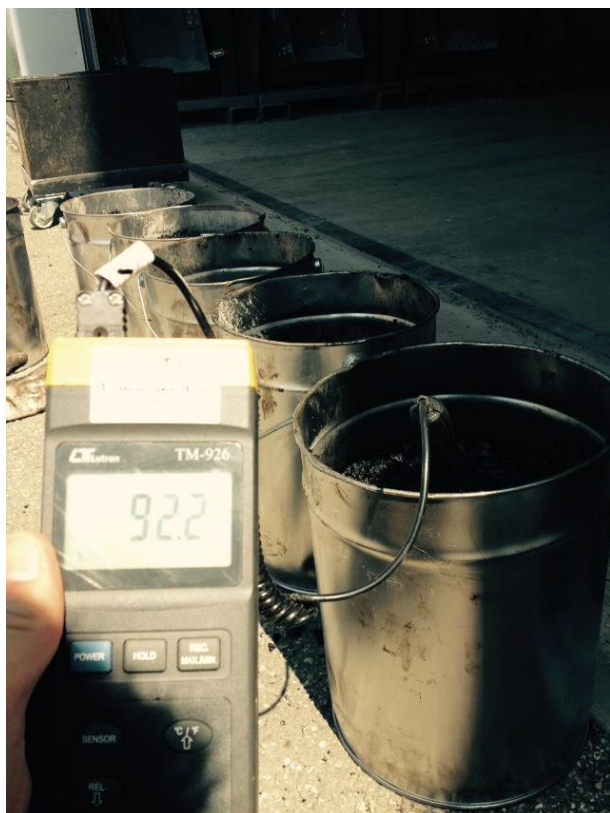
Het afkoelen van het asfaltmengsel voor temperatuursinterval [110-90]
