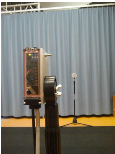
Foto 1. Rood-licht laser en reflector
