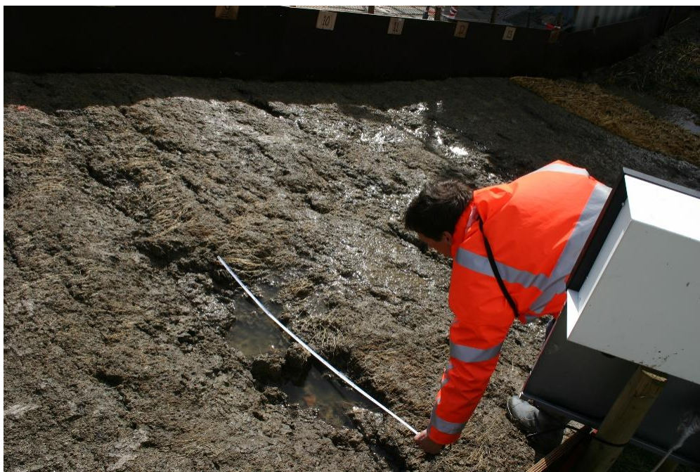
FIGUUR 12: VOORBEELD PEILSTOK MEETLINT (SCHULTZ, 2007)
