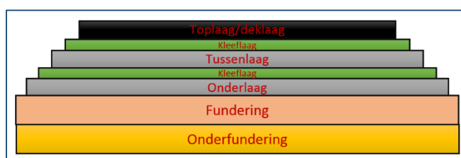
Figuur 30: Schematisatie van de opbouw van de wegverharding
