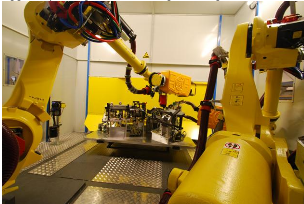
Figuur 1 Spotlascel met twee lasrobots
