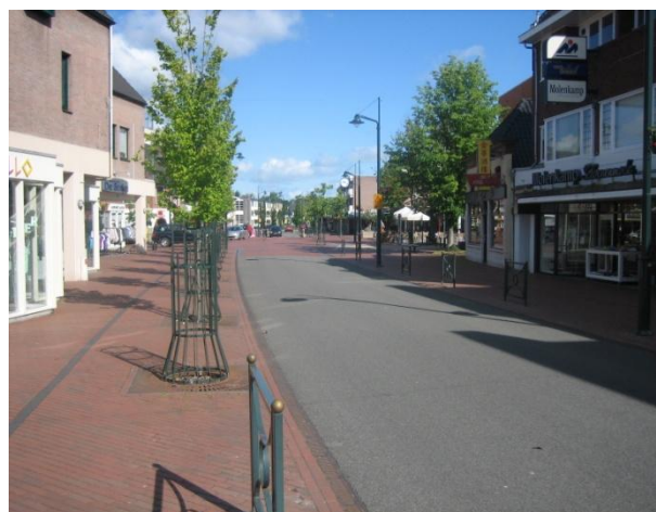
Figuur 21 - Bij de toeleidende wegen heeft de rijbaan een andere kleur dan het voetgangersgedeelte. Hekjes en bomen voorkomen dat er fout wordt geparkeerd.
