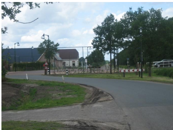
Figuur 6 - Door middel van een asverspringing wordt in Siegerswoude geprobeerd om de snelheid van auto's te verminderen.
