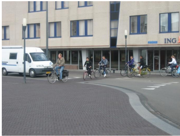
Figuur 32 - Voor fietsers is er op het Laweiplein een FOP aangelegd. Zij bevinden zich in een voorrangpositie.
