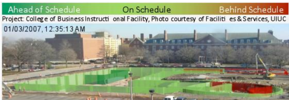
Figuur 11: De voortgang van de bouw kan worden geprojecteerd op een foto van de oude situatie. Groene objecten zijn volgens de planning gerealiseerd, de rode elementen hebben vertraging (Golparvar-Fard, Peña-Mora, & Savarese, 2009).
