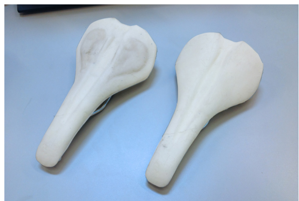
Figuur 2.33 : Giant® zadels gegoten in 3D geprinte matrijsen
