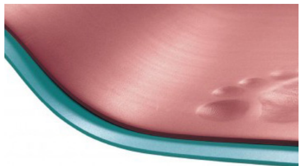
Figuur 2.23: plastazote (Polyethyleen schuim)
