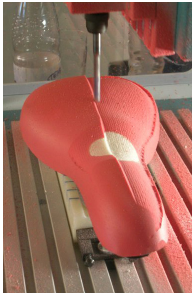
Figuur 2.31: het frezen van een custom zadel (Bikemedical)
