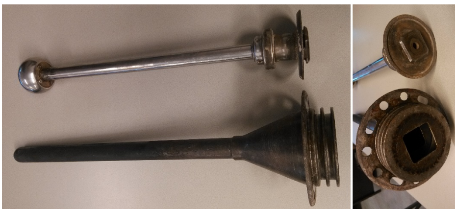
Figuur 1: Gebruikte adapter en huidig inzetstuk
