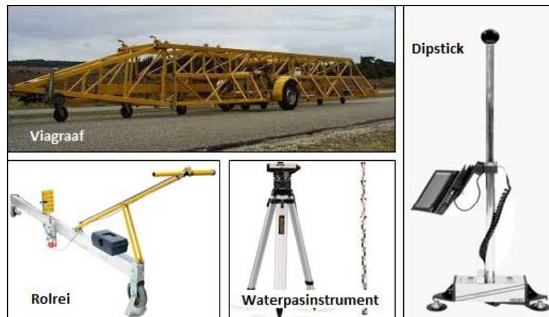
Figuur 9: Voorbeeld van een viagraaf, rolrei, waterpasinstrument en dipstick
