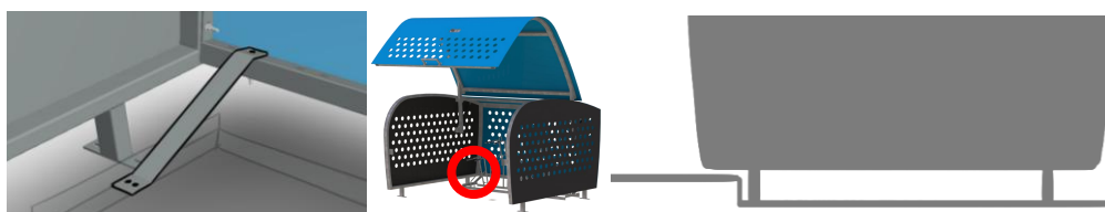
Figuur 25: Fietsenrek verankering aan de achterzijde van de fietstrommel (links en midden) en fietstrommel geplaatst over een stoeprand (rechts).
