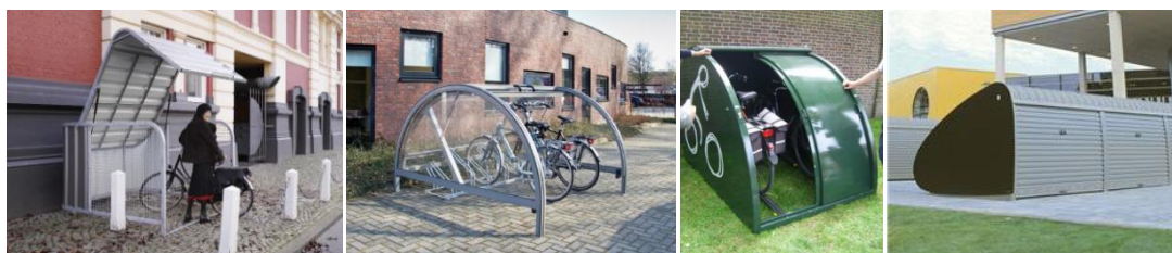
Figuur 10: (in leesrichting) CycleStore Box Klaver met omhoog-klappende deur, Jan Kuipers fietstrommel met broodtrommeldeur, fietstrommel in Brugge met schuifdeur en Velopa Plectrum met roldeur.
