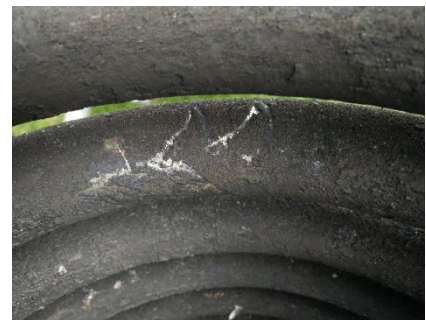
Figuur 16: Aanslag op spiraal zorgt voor lagere warmteoverdracht
