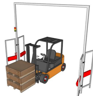
Figuur 4.2: RFID-poort voor bulk scannen (Bron: Nofilis bidirectional RFID-gate 6-6-2016)
