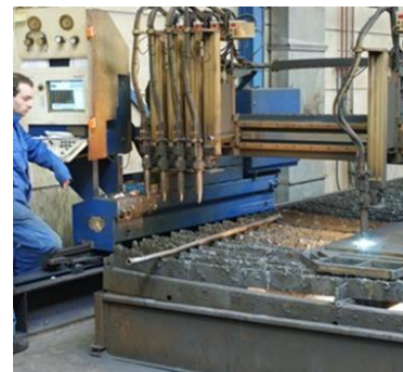
Figuur 2.5: Autogeen snijder (Foto MWA)
