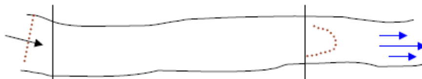
Figuur 2.6 Bovenaanzicht principewerking stokdrijver
