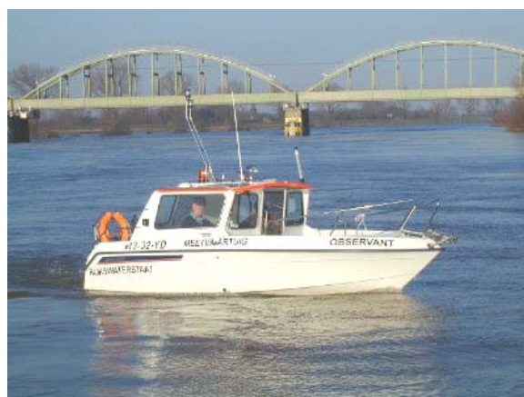
Figuur 2.14 Het door RWS-Limburg sinds 2001 gebruikte ADCP-meetschip, tijdens een hoogwatermeting in Ravenstein.
