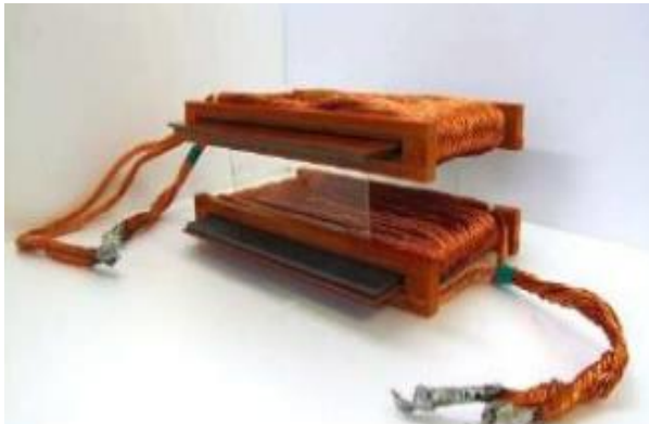
Figuur 3-6: Transmitterspoel en ontvangspoel inductie (Wu et al, 2011)
