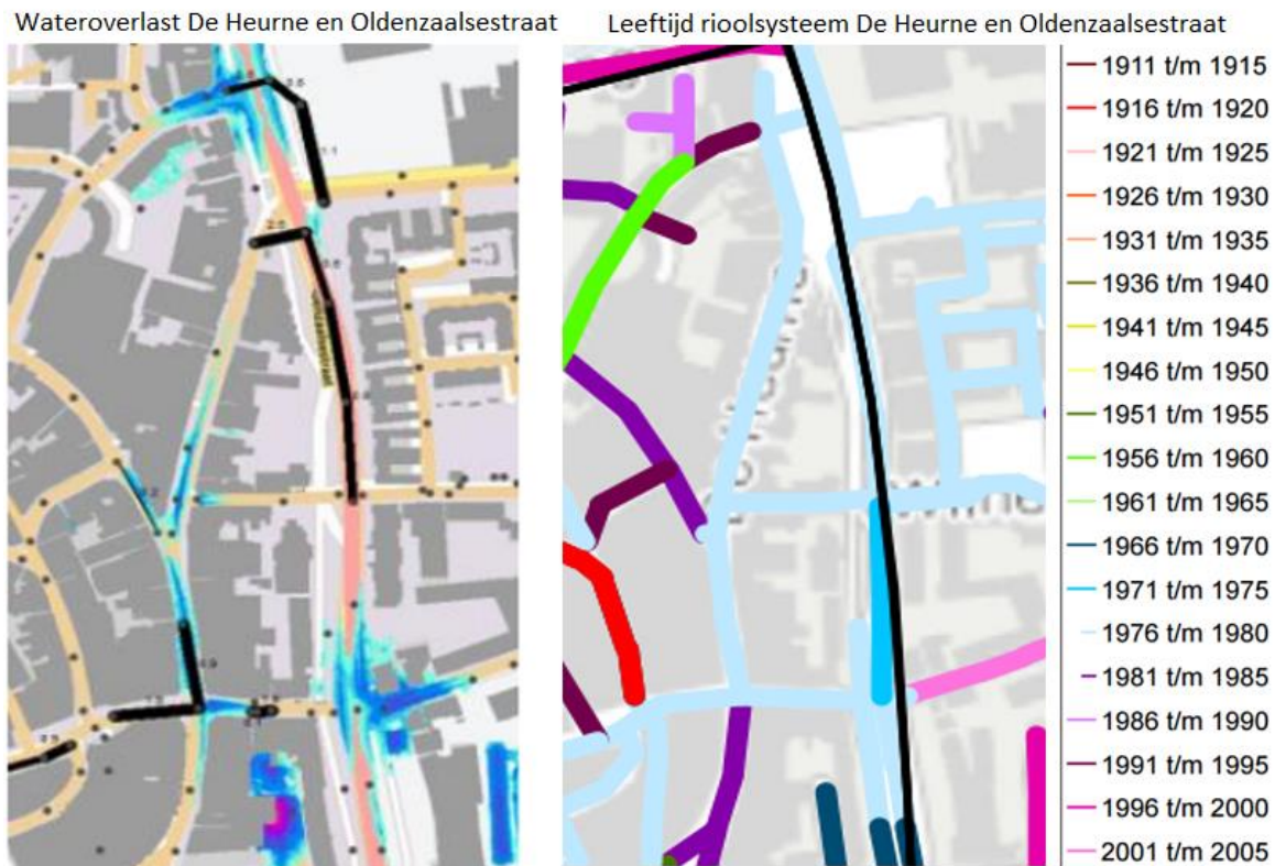
Figuur 4.1 Riolering van De Heurne en Oldenzaalsestraat met daarbij weergegeven bouwjaar, Enschede
