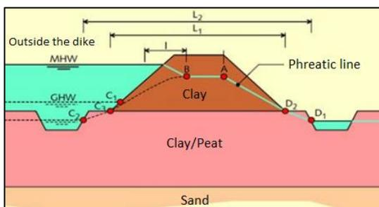
Figure 11: Phreatic line in a clay dike (Technische Adviescommissie voor de Waterkeringen, 2004)
