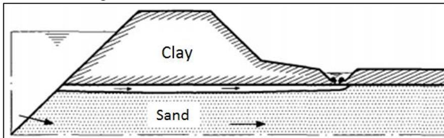
**Figure 14: The failure mechanism piping (Technische Adviescommissie voor de Waterkeringen, 1999).**
