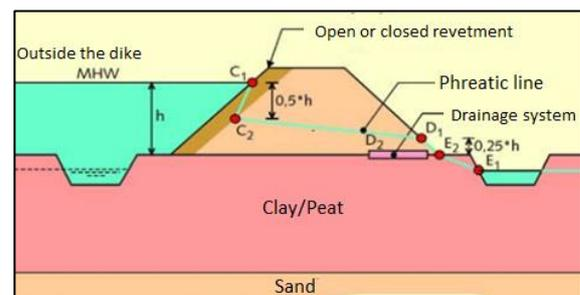
Figure 12: Phreatic line in a sand dike with clay cover (Technische Adviescommissie voor de Waterkeringen, 2004)
