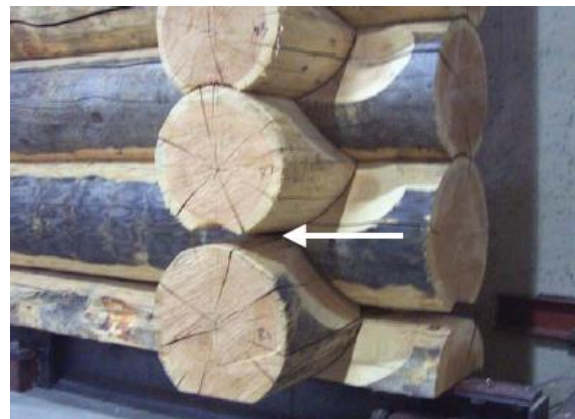
Figuur 3-6: Verticale uplift zorgt ervoor dat interlock-verbindingen niet meer nauw op elkaar aansluiten (Popovski, 2002)
