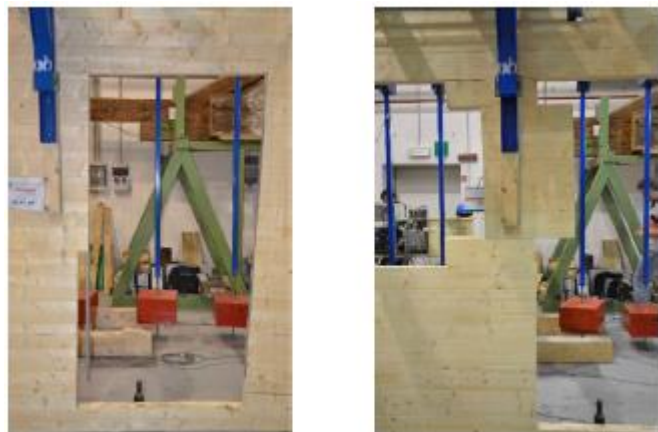
Figuur 3-4: Vervorming van openingen als gevolg van relatieve verplaatsing tussen logs (Grossi, Sartori, Giongo, & Tomasi, 2015)
