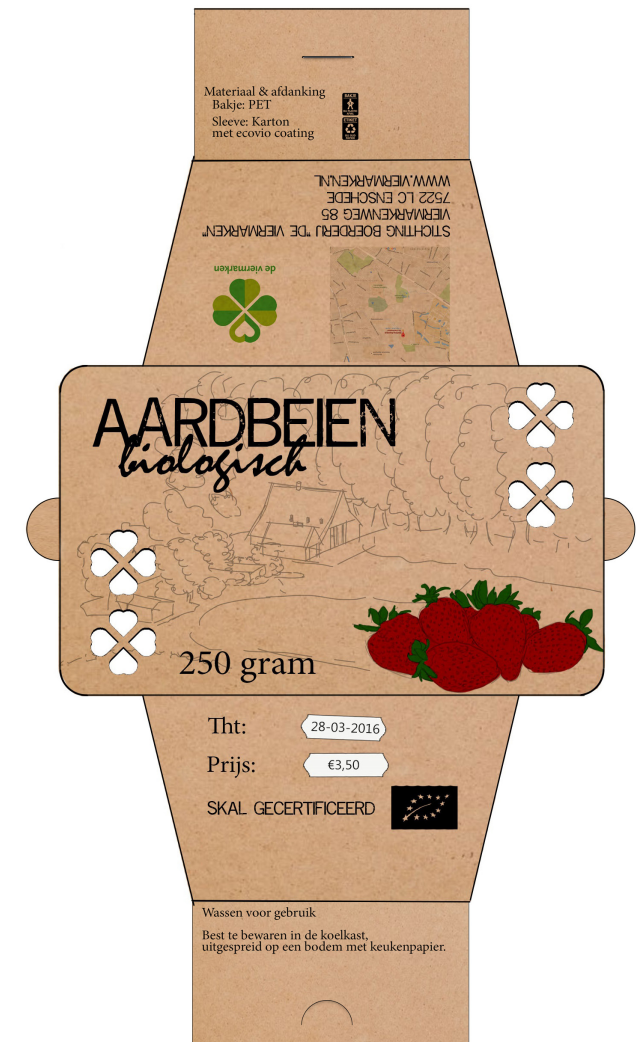
Figuur 38. Uitslag van de sleeve.
