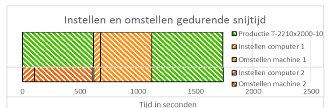
Figuur 16: Instellen en omstellen gedurende de snijtijd
