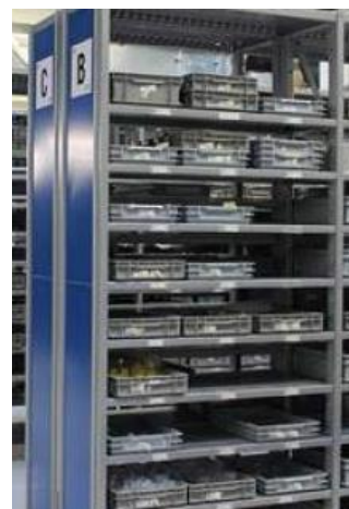
Figuur 18: Magazijnstelling met KLT's op drie posities per legbord
