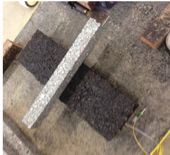
Figuur 24, asfaltbalk voor rekmetingen
