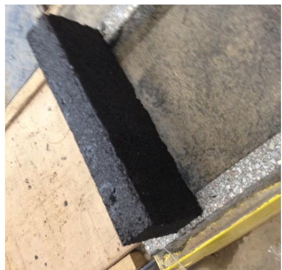
Figuur 25, asfaltbalk op de zijkant gelegd
