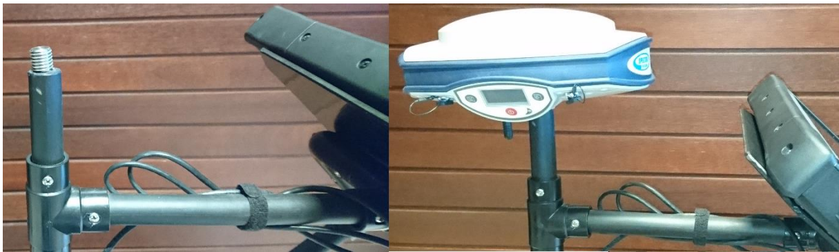
Figuur 22: Bevestigingspunt GPS & GPS bevestigd
