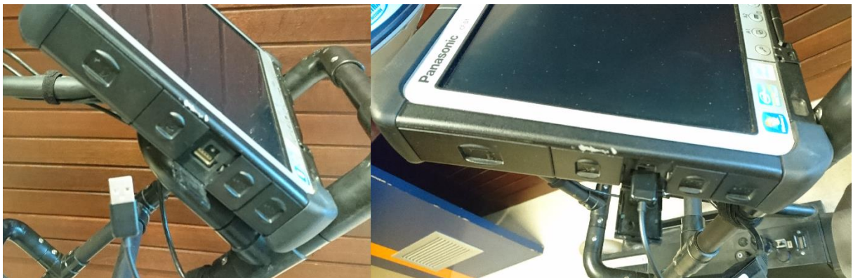
Figuur 23: Aansluiten kabel radar op Panasonic CF-D1
