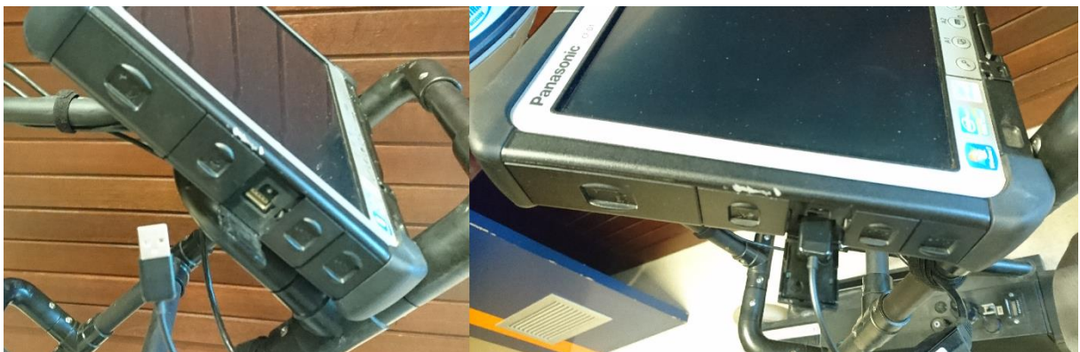
Figuur 23: Aansluiten kabel radar op Panasonic CF-D1
