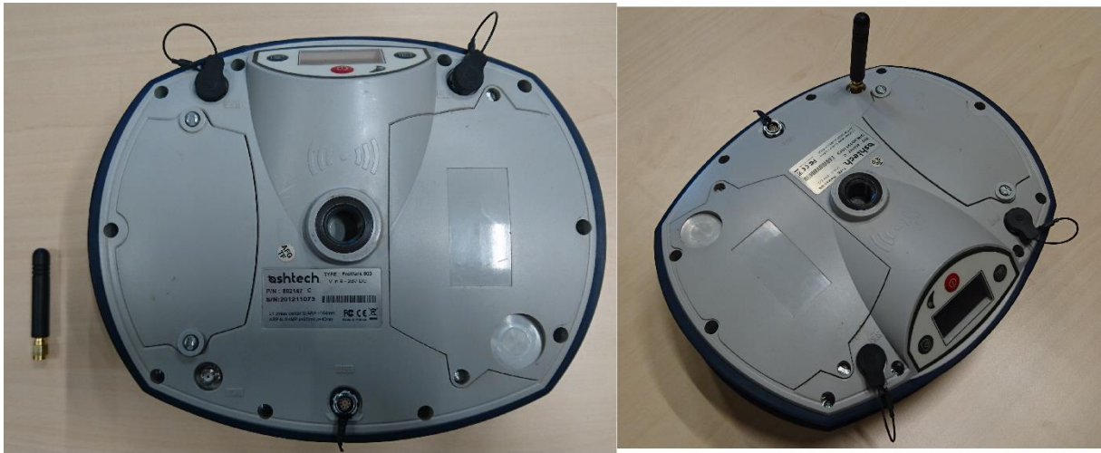
Figuur 21: Onderdelen GPS Ashtech Promark 800 los en in elkaar gezet
