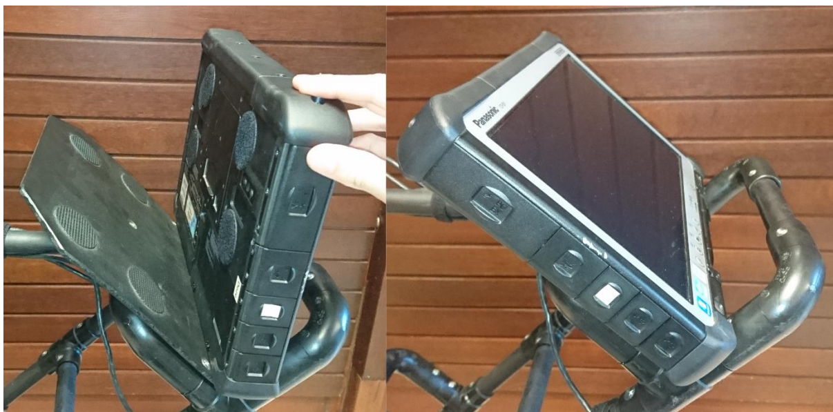
Figuur 20: Vastzetten Panasonic CF-D1 met klittenband op de grondradar
