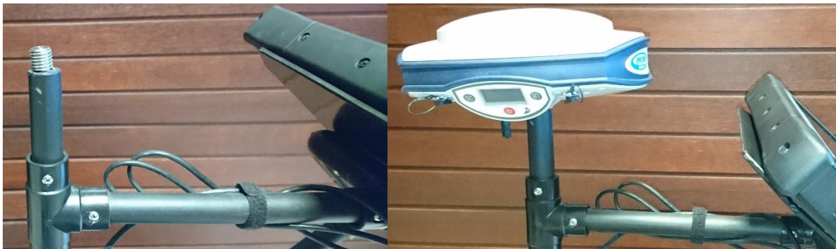
Figuur 22: Bevestigingspunt GPS & GPS bevestigd
