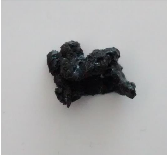
Figuur 22 polyesterpoeder na geltimetest
