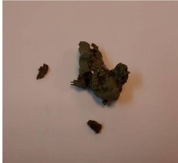
Figuur 23 restpoeder na geltimetest
