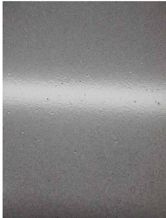
Figuur 42 stof en kraters in de coatinglaag
