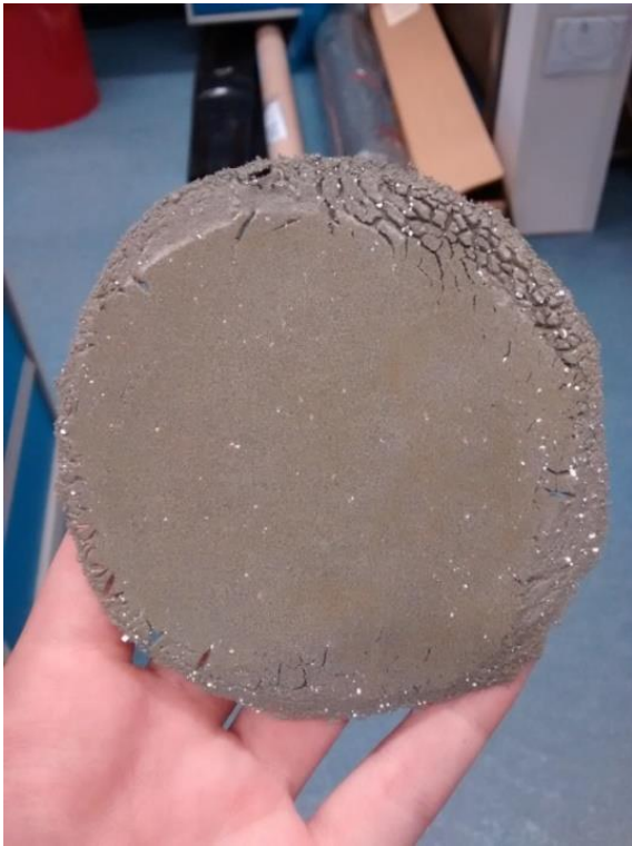
Figuur 23 uitgehard plaatje met anti-foam vlokken
