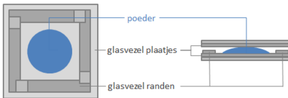
Figuur 18 schematische weergave boven- en zijaanzicht mal
