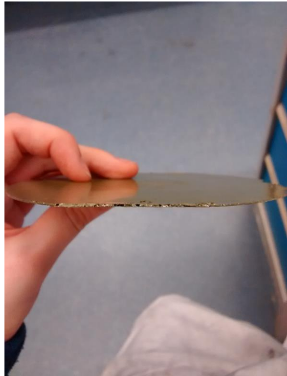
Figuur 11 doorsnede met luchtbellen
