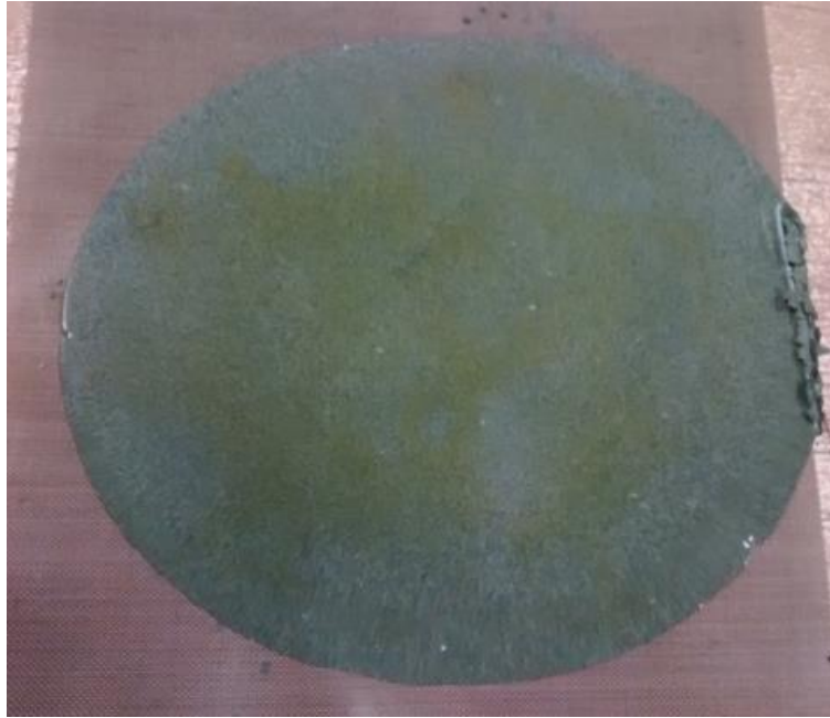
Figuur 20 uitgehard restpoeder met anti-foam
