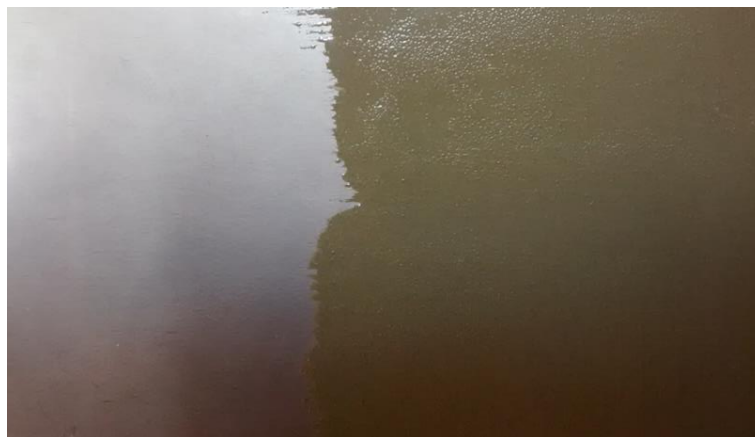
Figuur 25 verflaag met luchtballen
