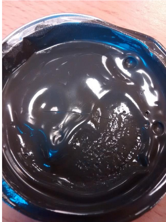
Figuur 39 ondiep sneetje in oppervlak
