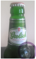
Figuur 3.1.33. Een eenmalig dichtgeknepen kroondop op een bierflesje (H).
