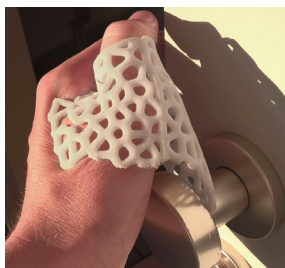
Figuur 2.6.2. Het prototype (M3) is een ingekorte variant van CM1 en blijft hier haken achter een deurklink.
