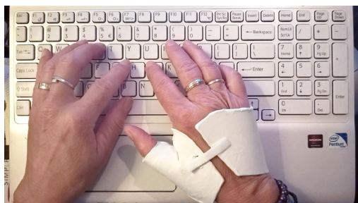
Figuur 7.7.1. Het testen van een handbrace met klikverbinding (CM008).
