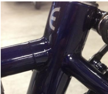
Figuur 12: TIG gelast Duet fietsframe
