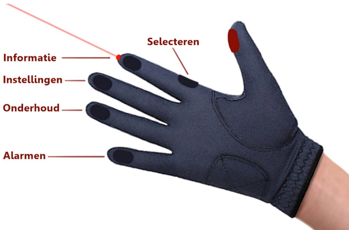
Figuur 6.7: Bediening via haptische handschoen
