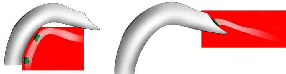
Figuur 68 Luchtslang wegwerking: Buitenom via kliksysteem (links) Door handvatstelsysteem heen (rechts)
