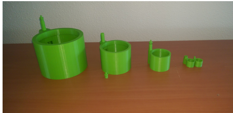
Figuur 28 Drukkamers voor verschillende buisdiameters met relatieve gelijke inhoud lucht
