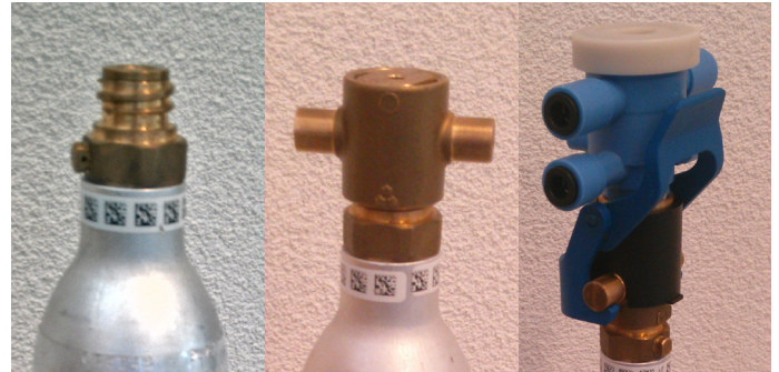
Figuur 3.9: Aansluiten klem-reduceerventiel, van links naar rechts
