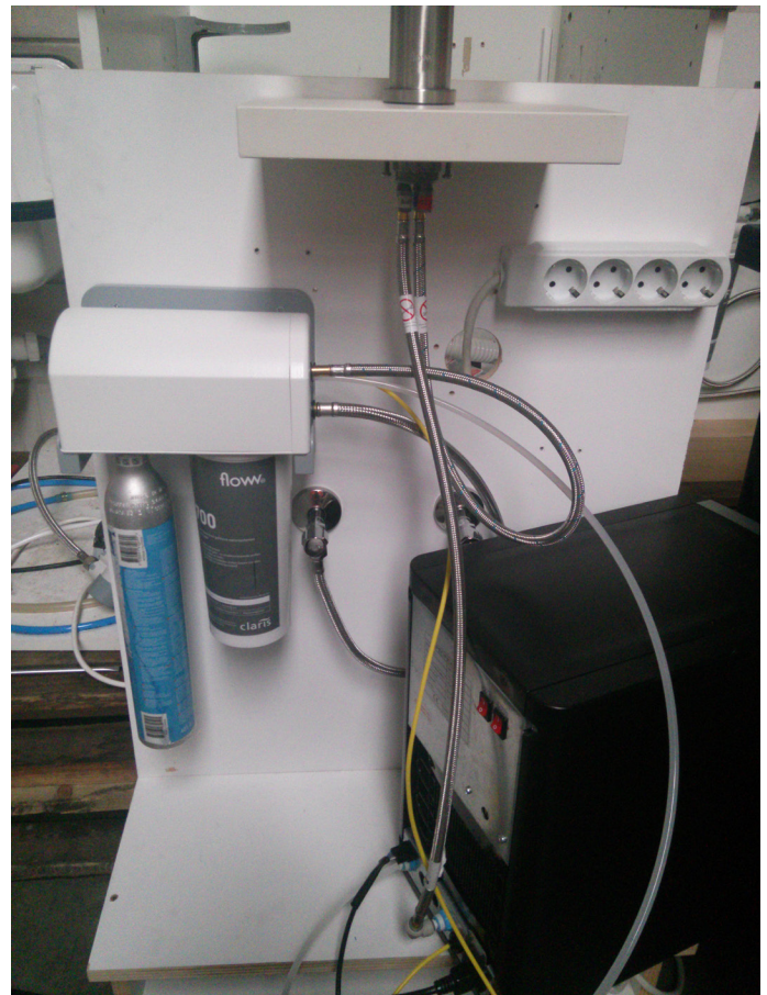
Figuur 7.4.1: Prototype aangesloten - boven: kraan, links: prototype inclusief cilinders, rechtsonder: chiller-carbonator
