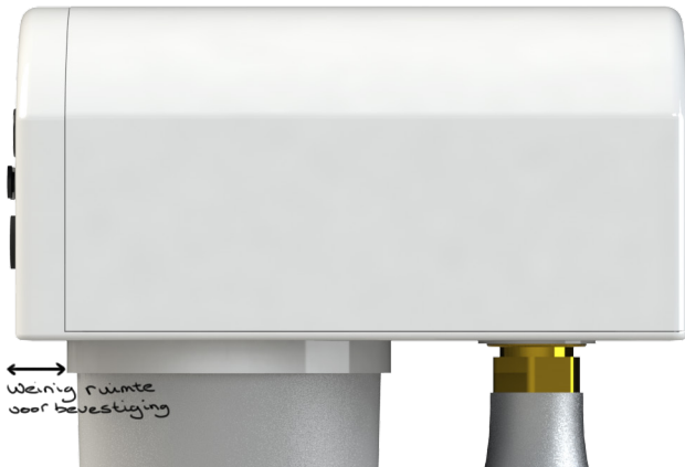
Figuur 6.5: Zijaanzicht SPARK - beschikbare ruimte voor bevestiging
