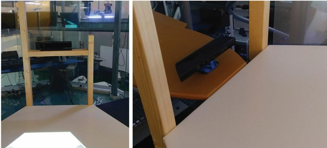
afbeelding 11.5 – respectievelijk de Kinect 2 voor het filmen van de gebruiker en de Kinect 1 voor het omzetten van het tafelloppervlak naar een touchscreen
