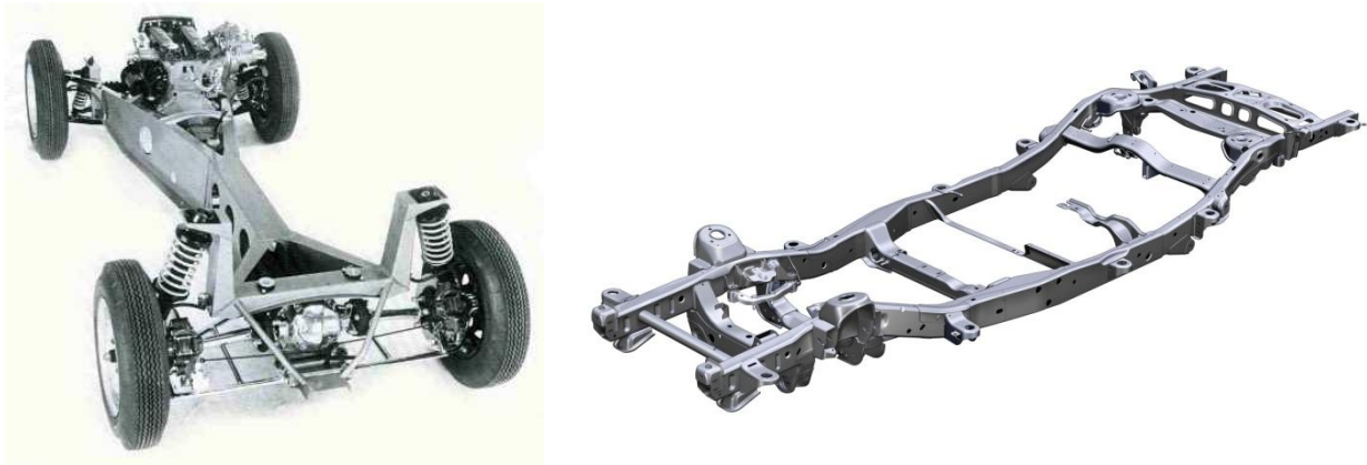
Afb. 27: Ruggengraat Frame (links) en Ladderframe (rechts)
