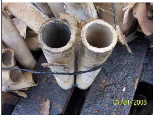
Afb. K-11 Linker buisje heeft gereageerd, rechter niet. Lont tussen de twee buisjes nog aanwezig
