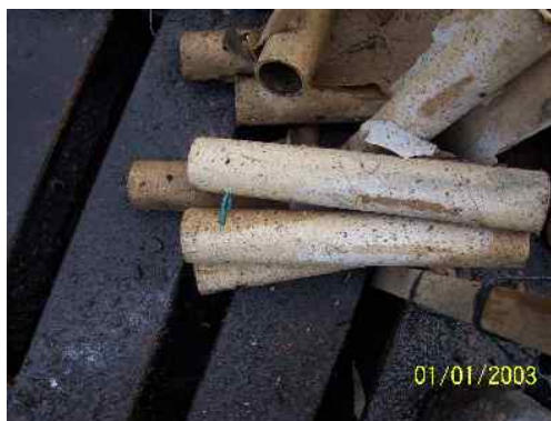
Afb. K-11 Linker buisje heeft gereageerd, rechter niet. Lont tussen de twee buisjes nog aanwezig
