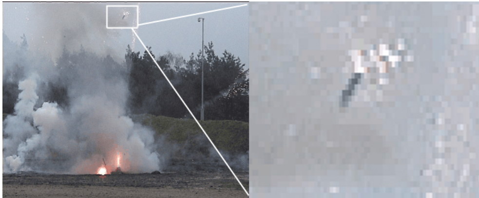
Afb. 5.6 Een buisje wordt meter hoog de lucht in geworpen door de explosie
