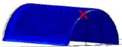
Figuur 15: Locatie overschrijding maximale druksterkte
