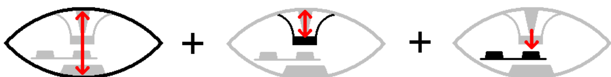
Figuur 29: De benodigde kracht voor het uitdrukken van de pil hangt van 3 factoren af
