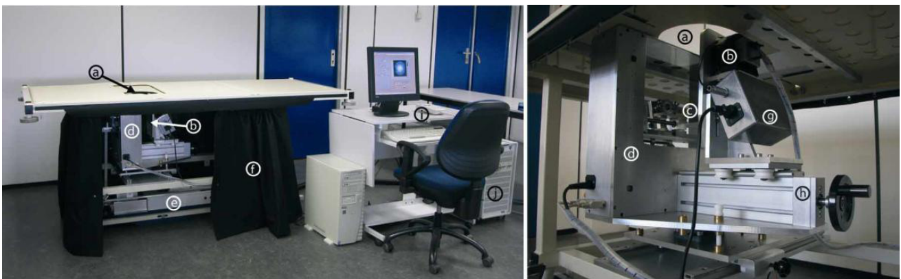
FIGUUR 1.1.1 - PHOTOACOUSTIC MAMMOSCOPE (PAM); a opening voor de borst, b ultrageluid detector matrix, c glazen plaat, d scansysteem compartiment, e laser, f gordijn voor de veiligheid van de laser tijdens gebruik, g electronica voor communicatie tussen detector en computer, h wiel om de detectormatrix met lichte druk tegen de borst te kunnen positioneren, i bediening van de laser, j energievoorziening van de laser.
