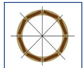
Figuur 51; Partjes en latjes uit een ronde stam
