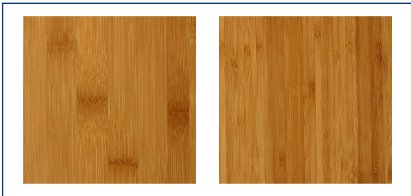
Figuur 58; Links plain pressed en rechts side pressed bamboe plaatmateriaal
