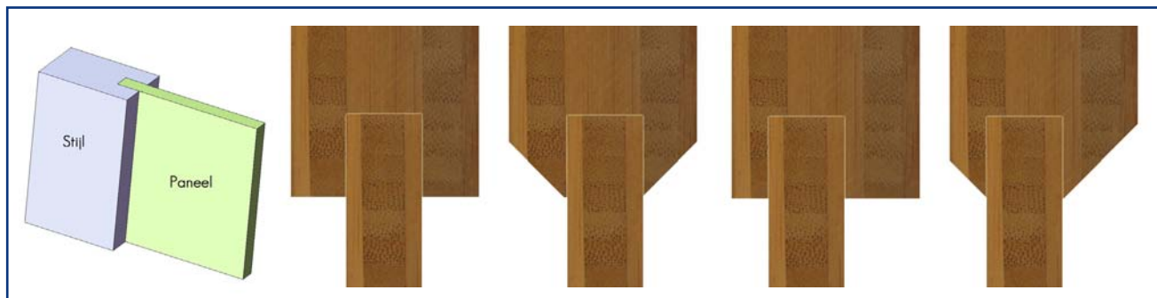
Figuur 77; Opbouw massieve deur
