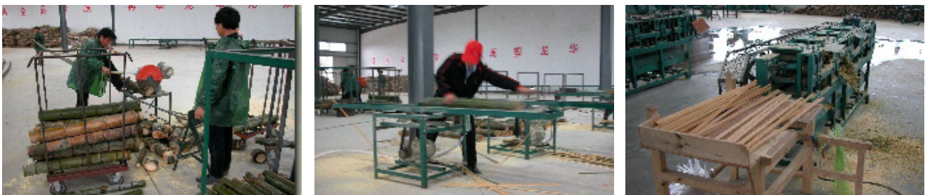
Figuur 52; Het maken van bamboelatjes
