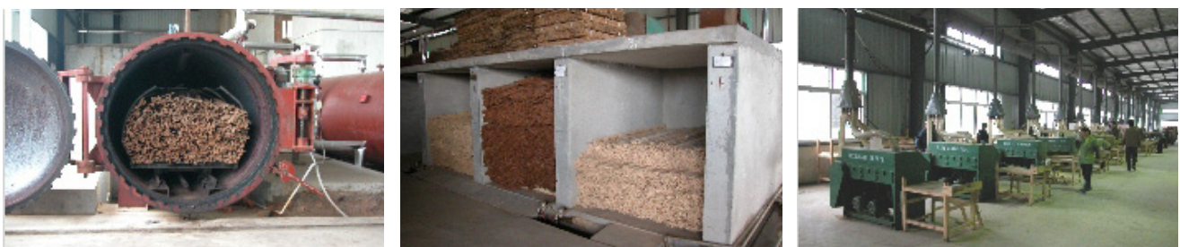
Figuur 53; Karamelliseren, drogen en schaven van bamboelatjes
