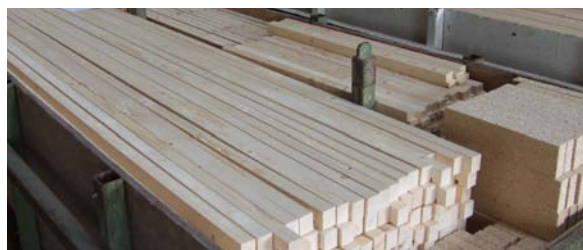
Figuur 15; Stijlen en dorpels van vuren en spaansplaat
