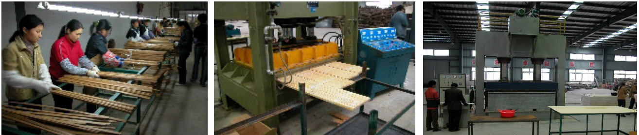
Figuur 54; Sorteren, insmeren met lijm en persen
