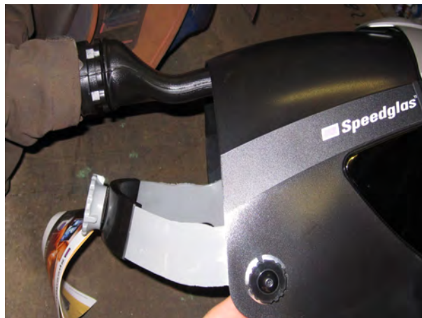
Afb. 1.10: Lashelm met luchtverversing.
