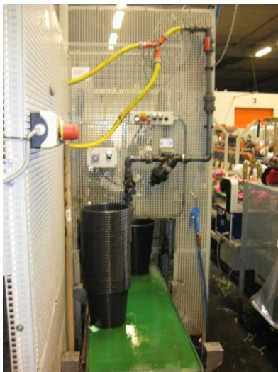
2. De emmers worden gevuld tot er een laag water van ongeveer tien centimeter in staat.
