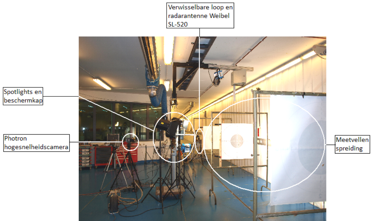
Figuur 25, testopstelling spreidingsbepaling
