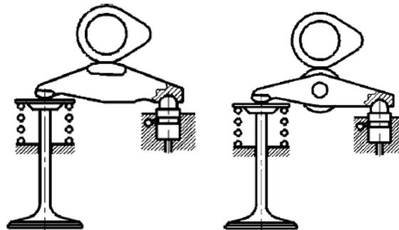
Fig. 3-1 Valve actuation using rocker arms (Trzesniowski, 2014)
