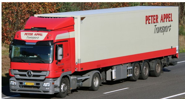
(a) Euro-Combi: Tractor and Eurotrailer (Verspaansdonk, 2013)
