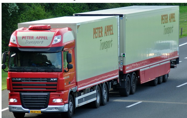
(a) Euro-Combi: Tractor and Eurotrailer (Verspaansdonk, 2013)
