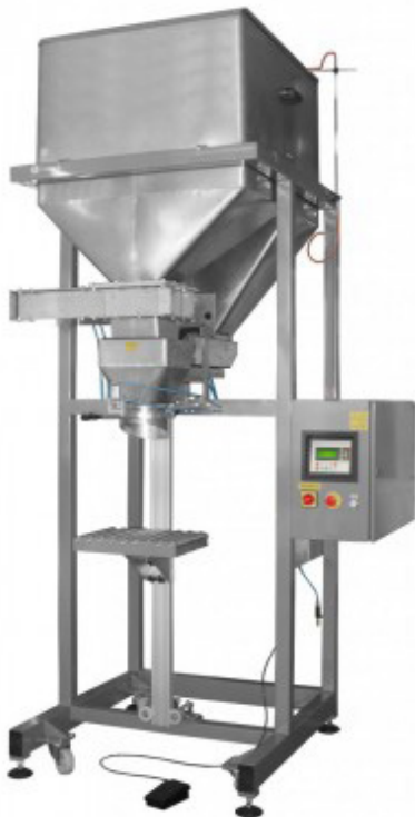
Figuur 17: Weegschaal doseerprincipe
