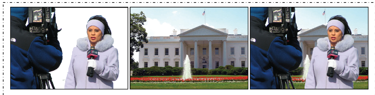
Afbeelding 1.7. Keying met transparantie-informatie. Links een voorbeeld; wit = transparant. Rechts het resultaat wanneer dit over een achtergrond wordt geplaatst.
