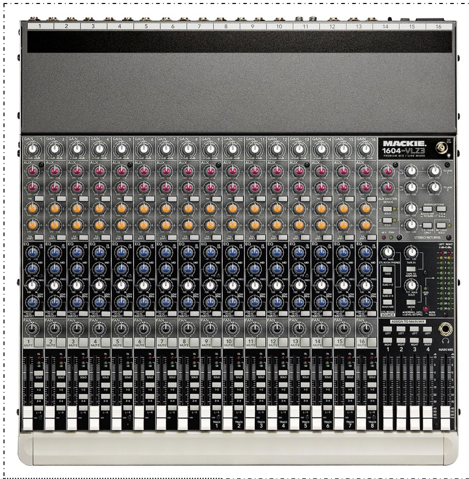
Afbeelding 2.1. Mackie 1604VLZ3 audiomixer. Deze mengtafel heeft 16 kanalen.
