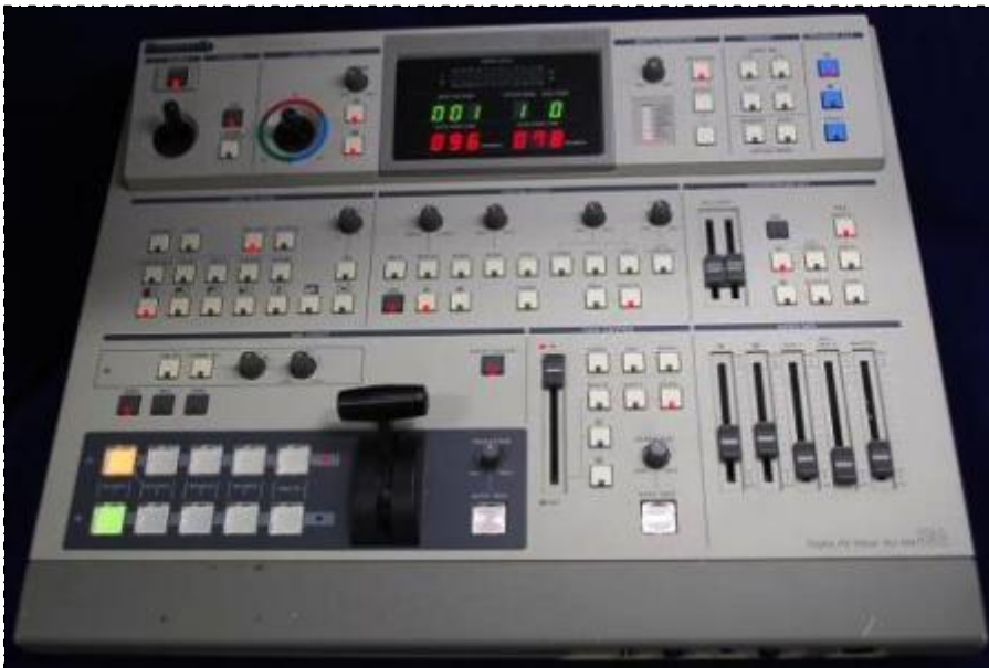
Afbeelding 3.2. Een Special Effect Generator (SEG). Dit voorbeeld is een switcher en SEG gecombineerd.
