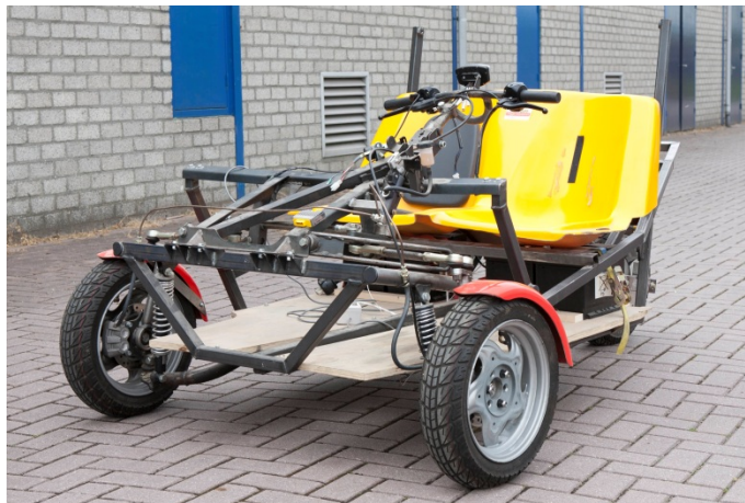
Figuur 4: Prototype chassis met stoelkuip originele Trigger
