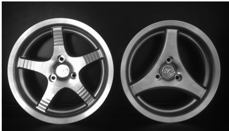
Figuur 47: Vijf- en drie-spaaks velgen (de imperfecties op de vijf-spaaks zijn ontstaan door een te grote stapgrote bij het frezen op de CNC freesmachine)
