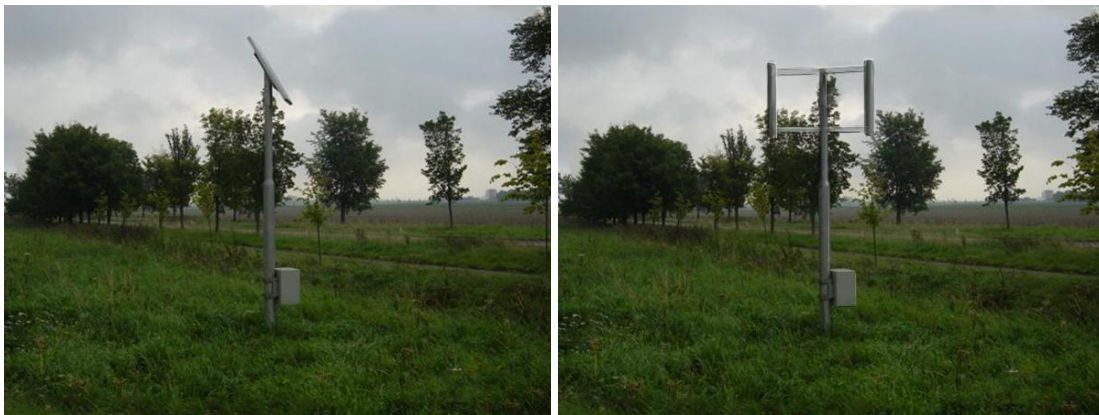
figuur 41 Telpunt voor verkeer (a) met zonnepaneel, en (b) met piëzoharvesters.
