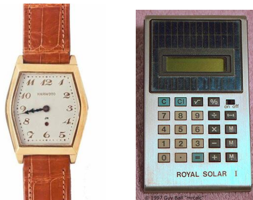
figuur 1 De eerste vormen van energy harvesting uit de omgeving. Links het eerste moderne automatische horloge van Schweiz. Rechts een van de eerste zon-gevoede rekenmachines, de Royal Solar 1
