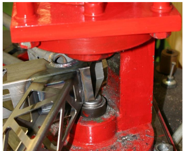
Figuur 65 De bracket voor de trapas kan niet ingeklemd worden in de richtbank
