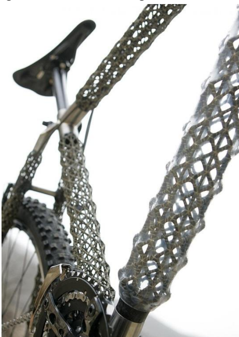
Figuur 7 IsoTruss frame
