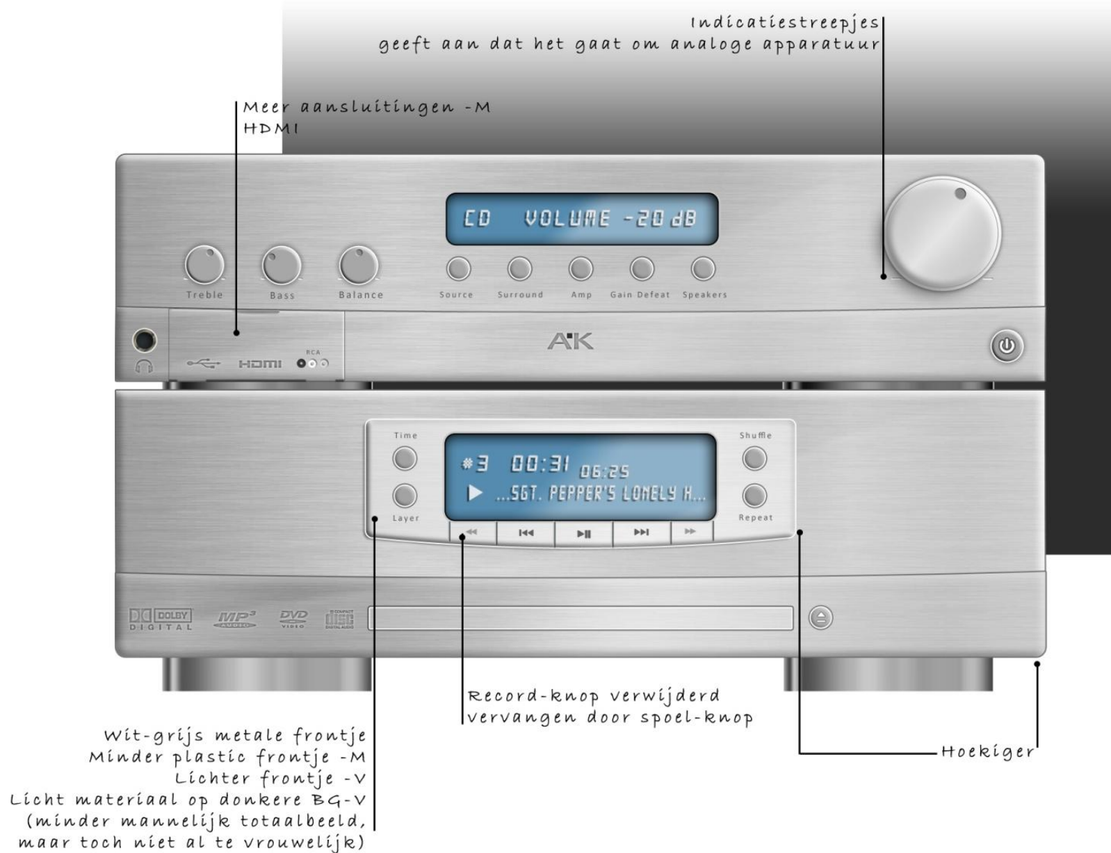
Figuur 6.6 Definitieve Onzijdige Hifi-installatie
