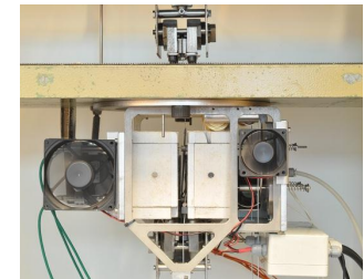
De pneumatische pers, onderdeel van de frictietester
