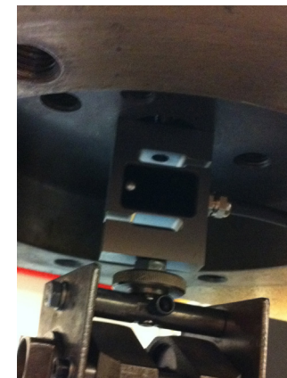
figuur 32 Load Cell tussen klem en traverse
