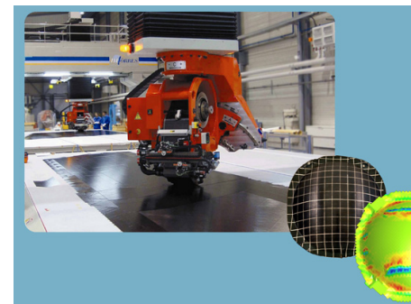
figuur 3 Productieproces waarbij een verwarmde stempel een vorm drukt in een vlakke plaat glasvezel versterkt thermoplast. Computer simulatie voorspelt de resulterende vorm.
