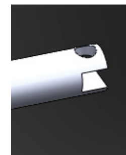
figuur 110 Uiteinde van de as met gat en gleuf
