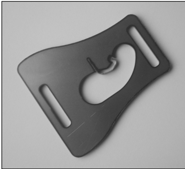
Figuur 45: De eerste onderdelen van het prototype, de staalplaat met het veertje erin.
