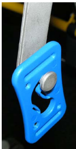
Figuur 5: correcte bevestiging van de clip
