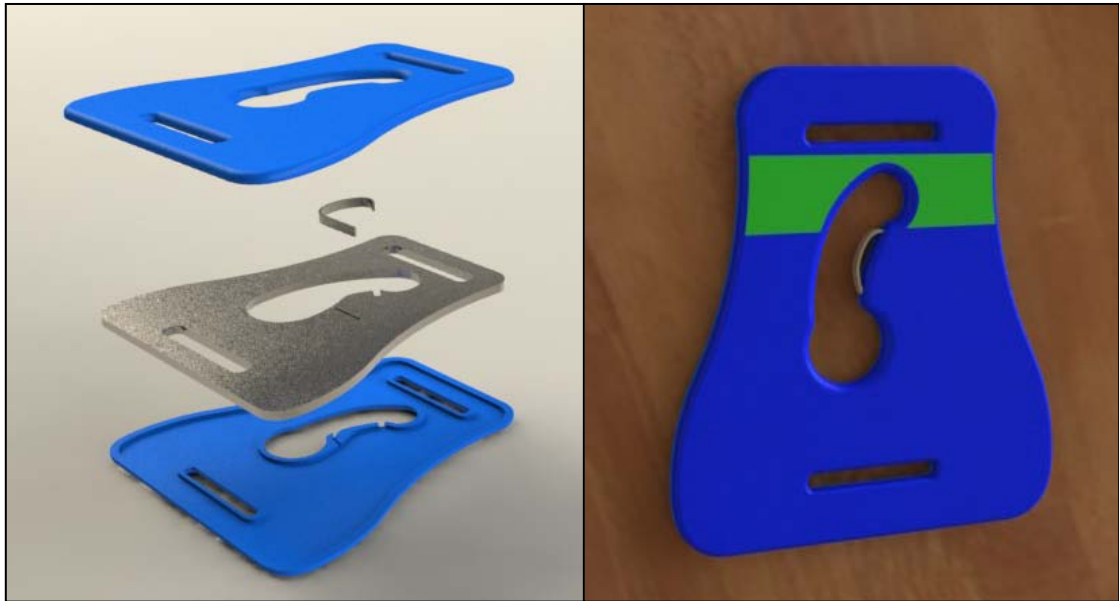
Figuur 44: Exploded view en render van het prototype (SolidWorks).
