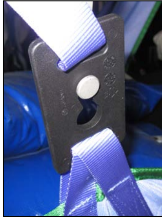
Figuur 10: Correcte bevestiging Arjo-clip
