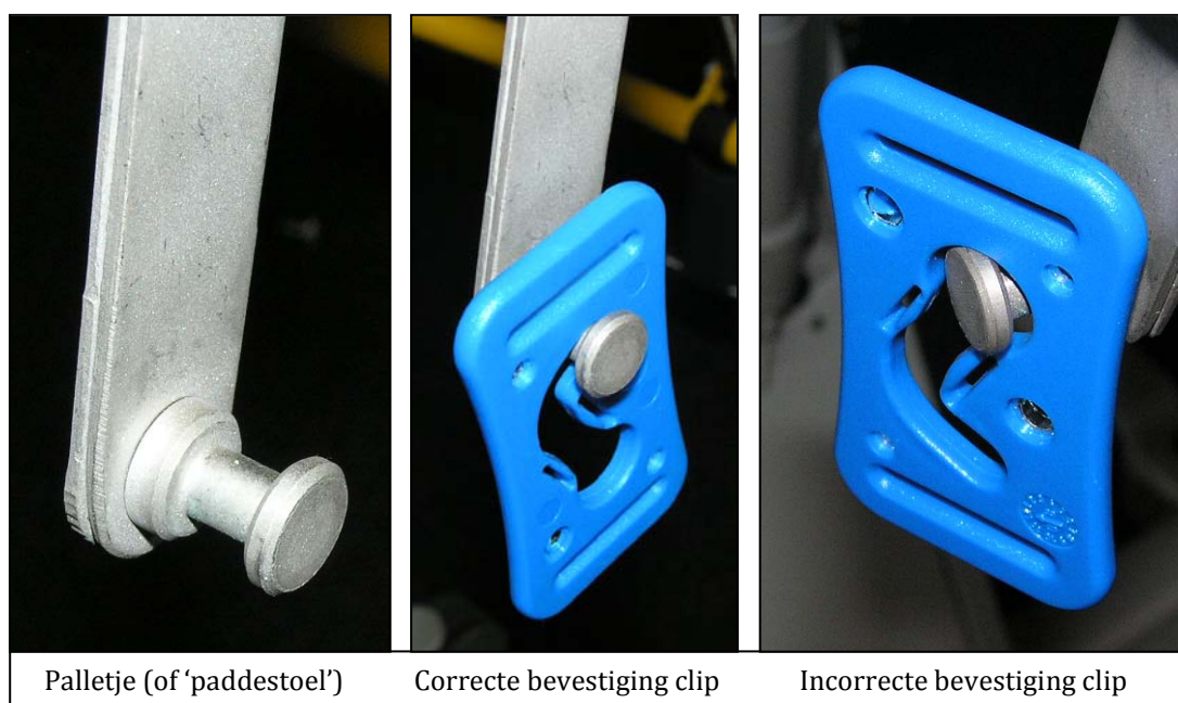
Figuur 7: Het verschil tussen een correcte en incorrecte verbinding
